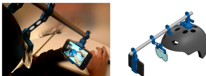
Figura 10 - Design de produto para usar o smartphone em um capacete, com a possibilidade de colocar óculos para ampliar a imagem da tela do smartphone
