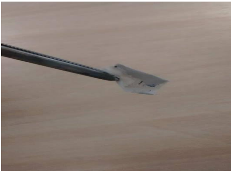
Figura 43 - Manta eletrofiada retirada do papel alumínio.
