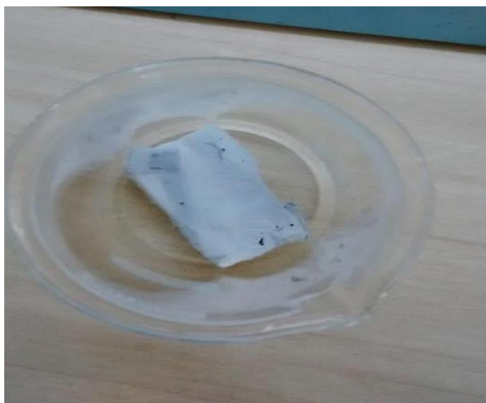
Figura 44 – Corpo de prova final utilizado para o ensaio de Guia de Onda
