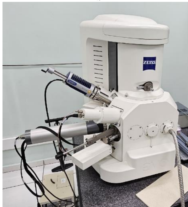
Figura 6 - Microscópio eletrônico de varredura ambiental Zeiss EVO LS 15 com EDS e EBSD
