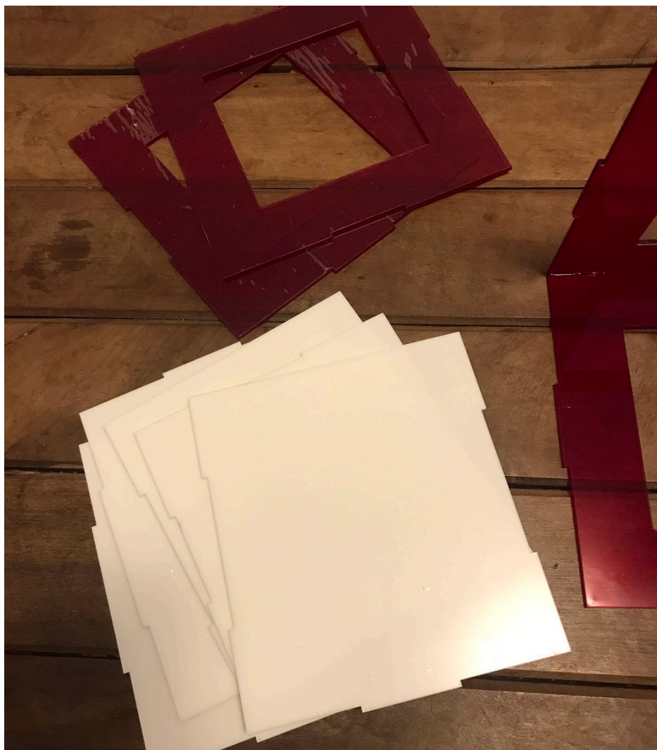
Fig. 57 - Peças em acrílico da cúpula cortadas a laser
