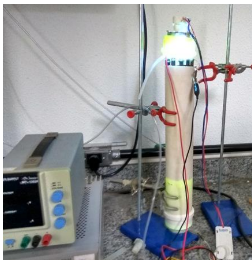
Figura 24 – Fotografia do reator fotoeletroquímico anular de bolhas em operação Fonte: do autor.
