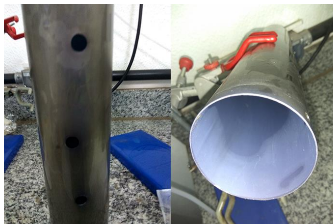
Figura 17 – Eletrodo tubular de nanotubos de \text{TiO}_2 com furos. Foto com visão externa e interna do eletrodo
