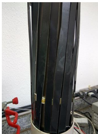
Figura 23 – Contra eletrodo de DSA com área superficial de 300 cm 2 Fonte: do autor.
