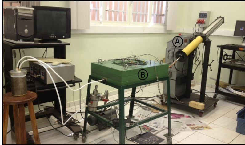
Figura 4.2 – Representação do sistema RTM e acessórios: A) injetora e B) molde
