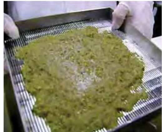
Processo físico de peneiramento para separação das frações sólida e líquida.
