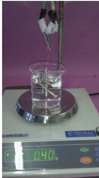
Figura 2: Fotografia representando a obtenção do volume pelo método de Archimedes.
