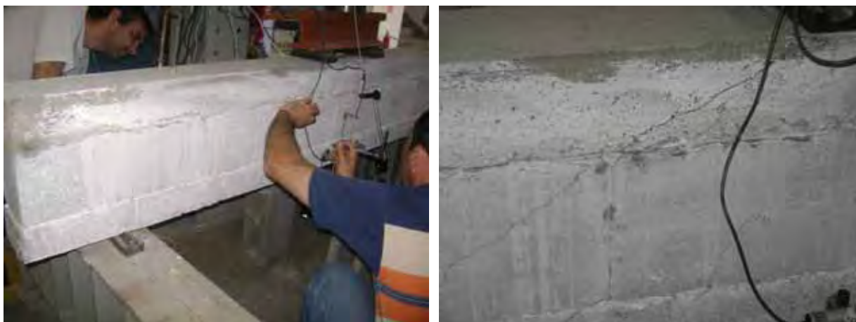
Figura 18 - Acompanhamento do histórico de fissuração.
