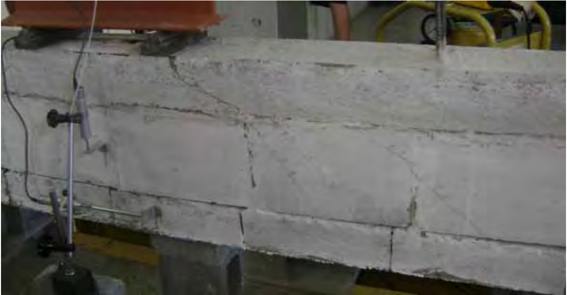
Figura 43 - Fissura típica de cortante no concreto da parte superior – Viga 1 e Viga 2 – VIDupla
