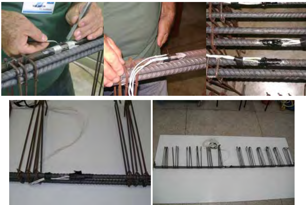
Figura 12 - Etapas de colagem dos extensômetros na armadura longitudinal.
