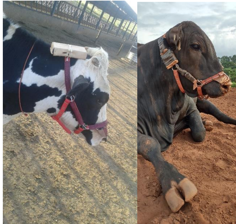
Figura 15. A. Cabresto primeira versão dispositivo “FRMaia” Maia et Al. 2016 em vacas leiteiras. B. Cabresto e dispositivo nova versão In_Comfort_Sensor Maia et Al. 2022 em bovinos machos.
