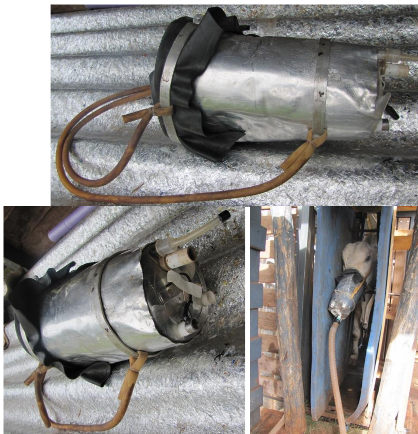
Figura 3. Máscara facial desenvolvida no laboratório de Bioclimatologia Animal da UNESP – Jaboticabal
