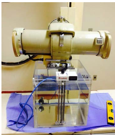
Figura 12 – Dispositivos dosimétricos posicionados no equipamento de Ortovoltagem Philips RT 250.
