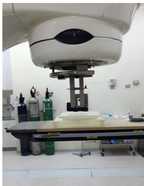
Figura 14 – Irradiação dos conjuntos de TLD's no A.L..
