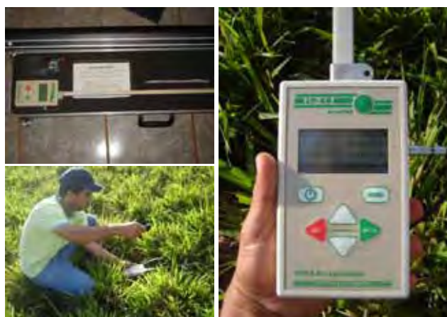
Figura 4 - Aparelho medidor de dossel do Capim-tanzânia
