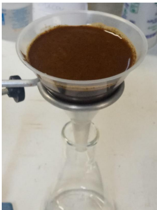
Figura 1: Montagem do ensaio para determinação de líquidos livres Fonte: Autora, 2022.
