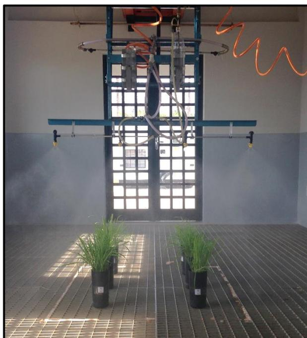
**Figura 2.** Pulverizador estacionário utilizado para a aplicação dos tratamentos.
