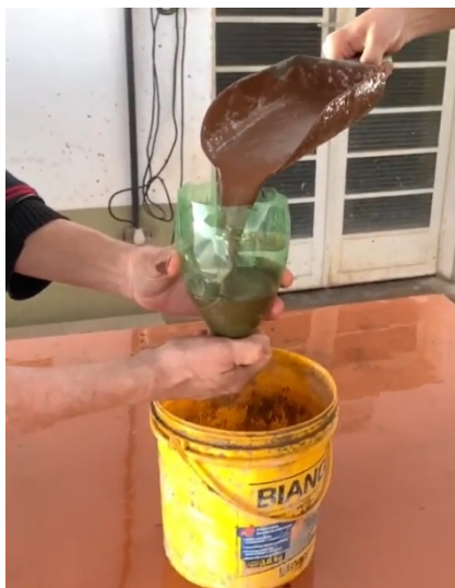
Figura 4 – Ensaio do tempo de escoamento em funil.
