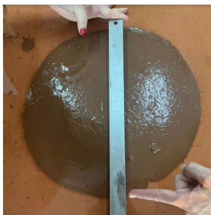
Figura 2 – Medição do ensaio de diâmetro de espalhamento.
