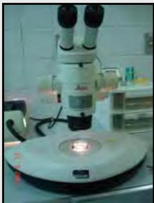
Fig 11: Lupa estereomicroscópica
