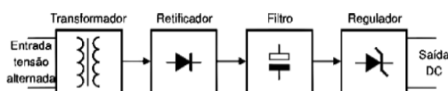
Figura 9 – Diagrama de blocos de uma fonte linear
