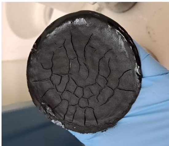
Figura 3. MWCNTs funcionalizados e filtrados em membrana.
