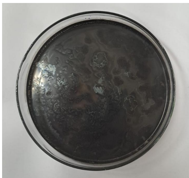
Figura 4. Compósito de MWCNTs/BNC-AgNPs.
