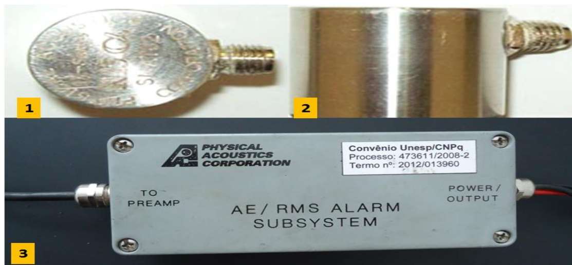
Figura 25. Vista do modulo de emissão acústica (1,2), e amplificador de sinal (3).
