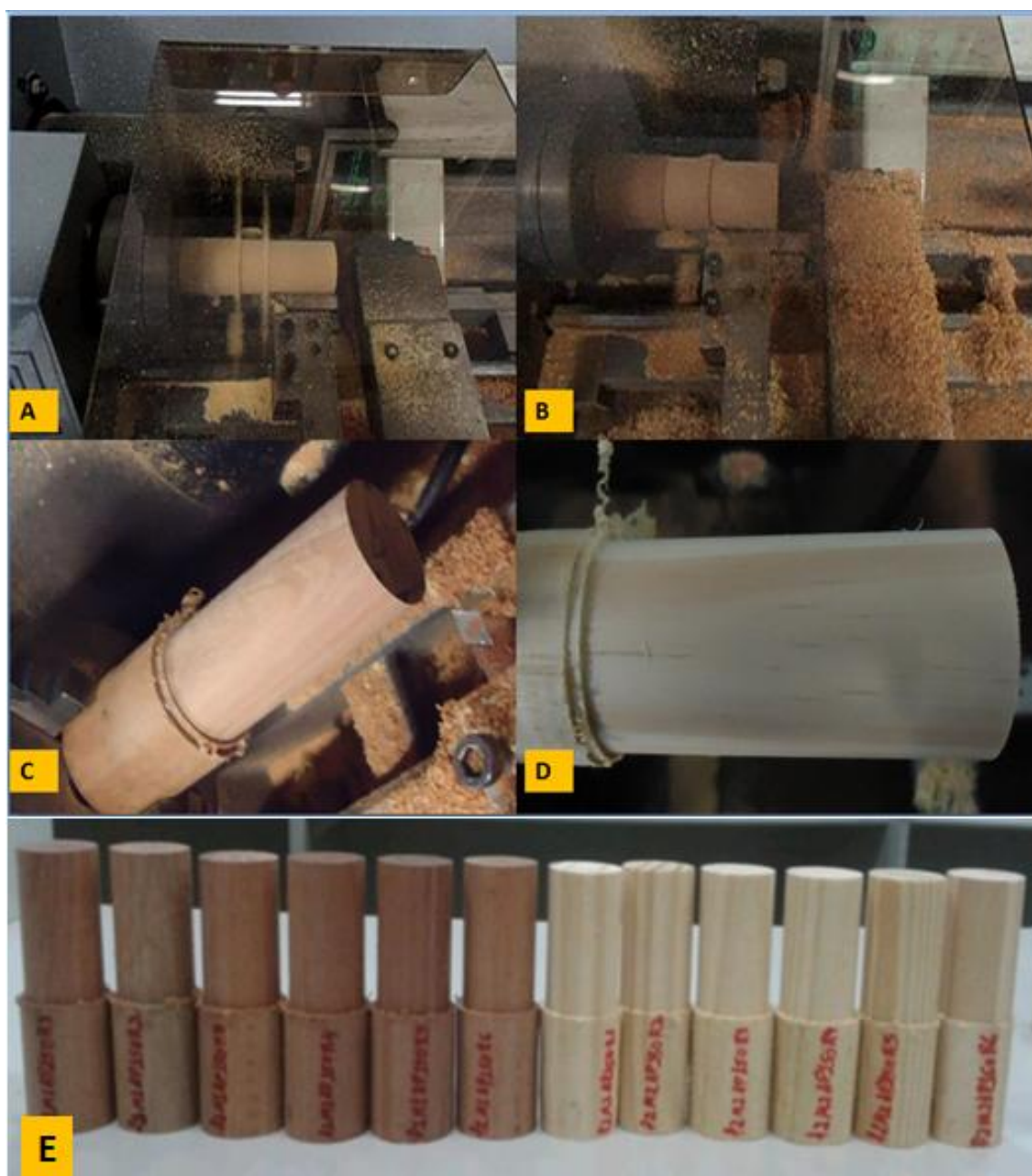
Figura 33. Vista do torneamento (A,B) acabamento das peças (C,D) e amostra do lote com os 12 procedimentos diferentes de torneamento (E).
