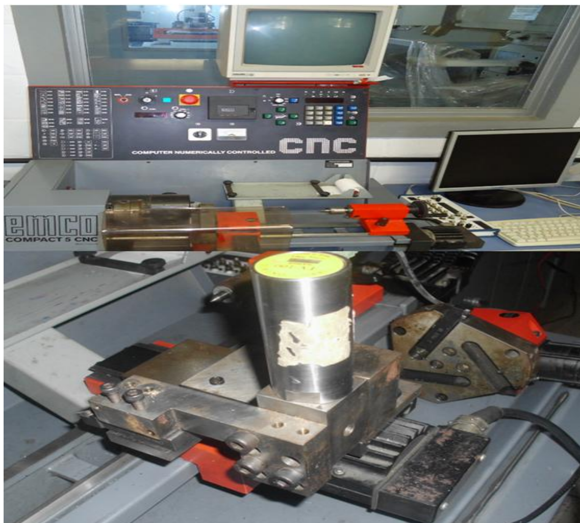
Figura 24. Torno utilizado e novo magazine de ferramentas desenvolvido para torneamento.
