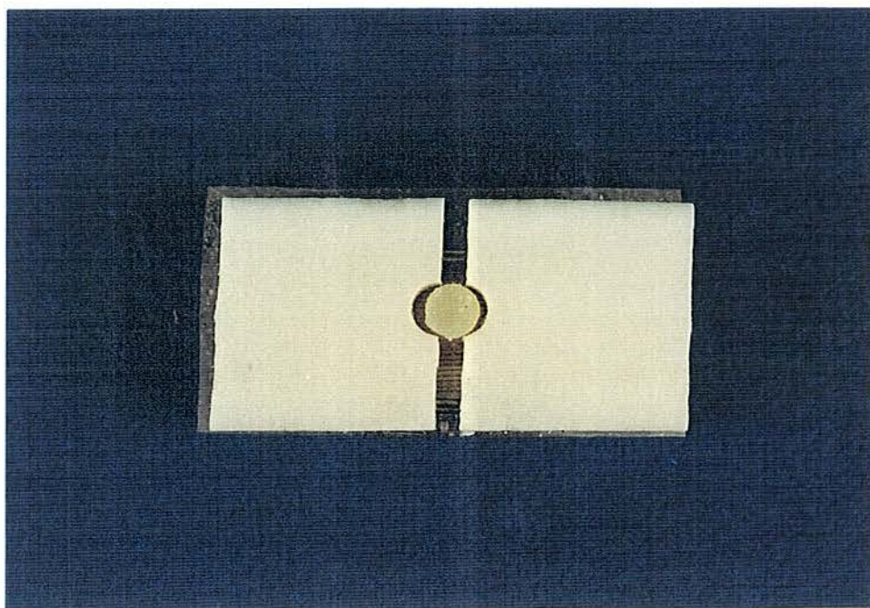
FIGURA 4- Separação da matriz de teflon, evidenciando o cilindro de resina composta.
