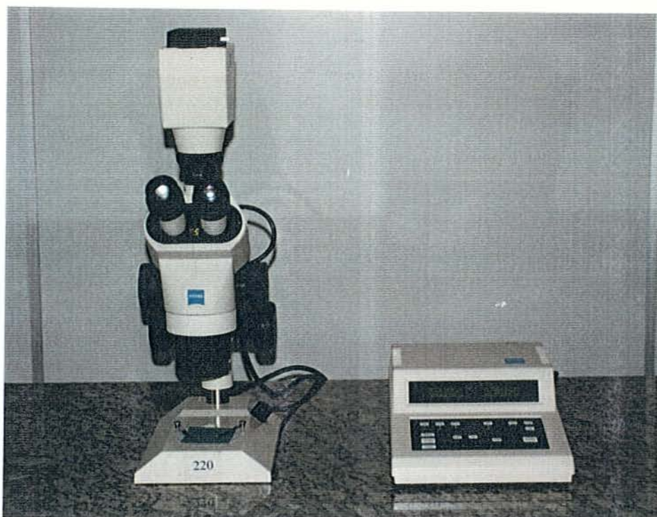
FIGURA 6- Estereomicroscópio utilizado para verificação do tipo de fratura.
