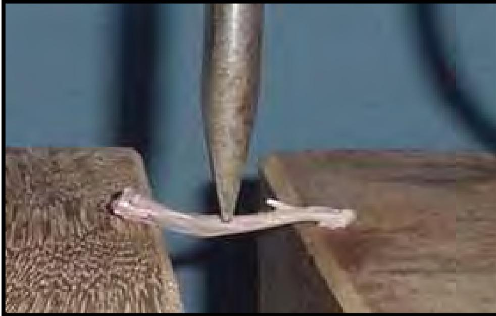
Figura 9 – Detalhe do corpo de prova montado em dois apoios e do cutelo de aplicação de carga locado em ponto eqüidistante às extremidades.
