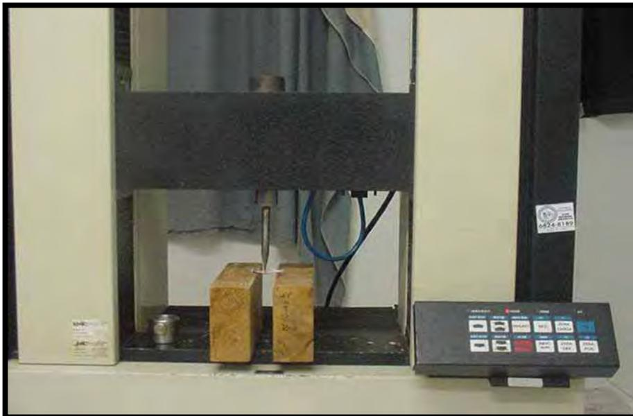
Figura 8 – Aspecto da Máquina Universal de Ensaios Mecânicos com o corpo de prova montado para o Ensaio de Flexão em Três Pontos.
