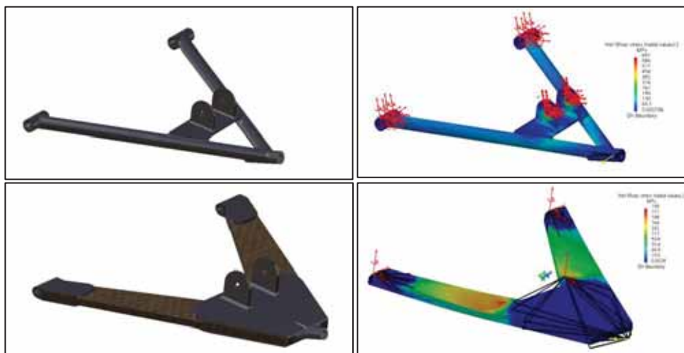
Figura 15 - Otimização de suspensão de um veículo Baja SAE (LIMA, 2011)
