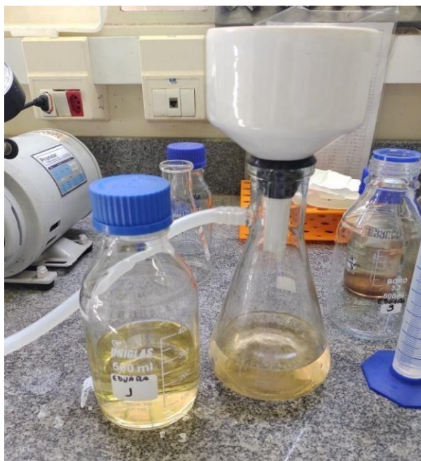
Figura 5- Filtração e coleta do líquido de lavagem da etapa da extração alcalina.
