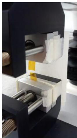
Figura 10 - Corpo de prova após o rompimento durante a realização do ensaio de tração.
