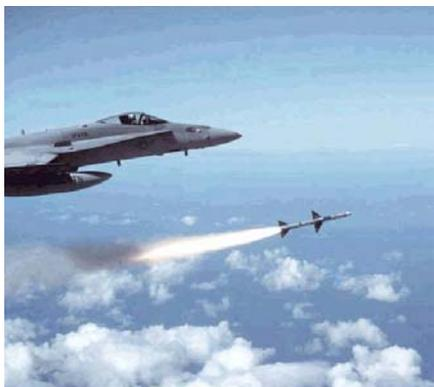
O AIM-7 Sparrow é um míssil guiado por radar com ogiva altamente explosiva. A série AIM/RIM-7 é de mísseis semi-ativos, ar-para-ar, com alta capacidade operacional para atacar aeronaves e mísseis de qualquer direção. É largamente utilizado pelos Estados Unidos e pelas tropas da OTAN. Durante a guerra do Golfo, provou ser uma potente arma ar-para-ar utilizada pelos pilotos da Força Aérea, abatendo 22 aeronaves de asa fixa e três helicópteros iraquianos.
