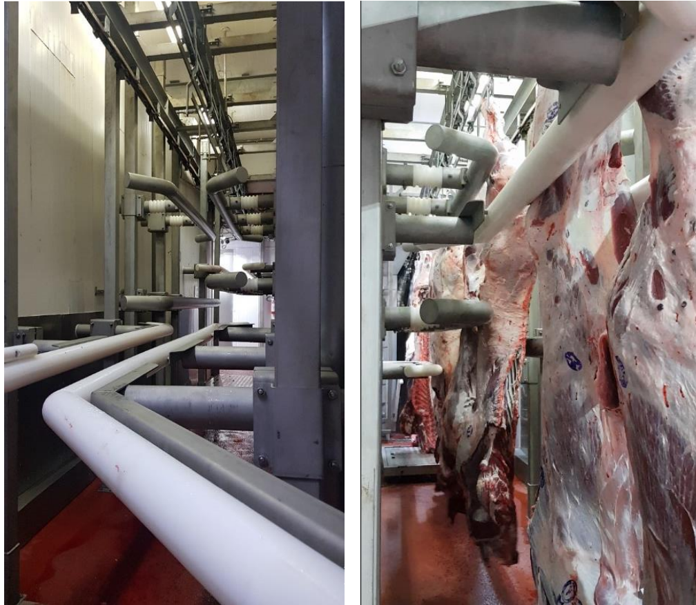
A) Estimulador elétrico. B) Carcaças passando pelo estimulador elétrico. Fonte: Elaborado pela autora (2021).
