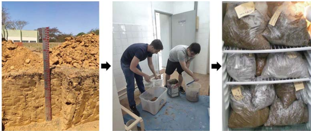
Figura 11 - Amostragem e preparação do Cambissolo distrófico coletado nas dependências do Câmpus da FEG/UNESP
