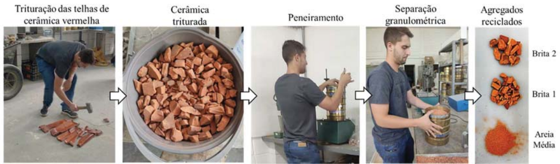
Figura 6 – Preparação dos agregados reciclados de cerâmica vermelha
