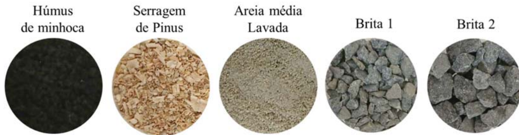
Figura 7 – Materiais filtrantes utilizados no Sistema BioÁgua Familiar
