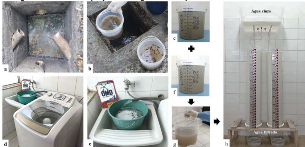
Figura 10 – Coleta e preparo das águas cinzas para tratamento nos biofiltros
