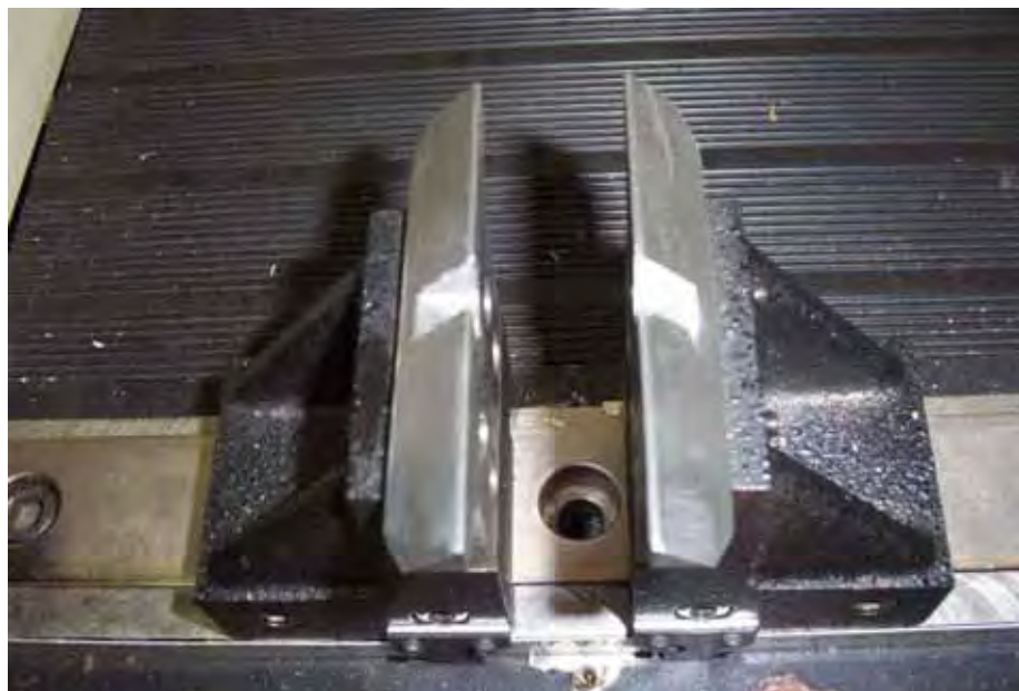
Figura 3. Peça em aço, confeccionada para apoio das peças óssea do estudo.
