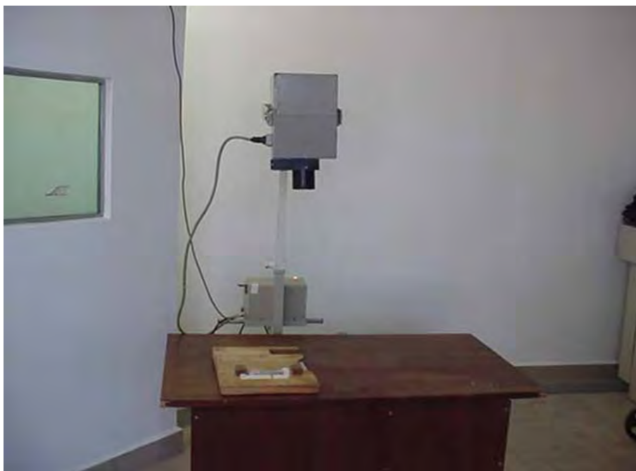
Figura 5. Aparelho de raio-X utilizado nas coletas de imagens radiográficas.
