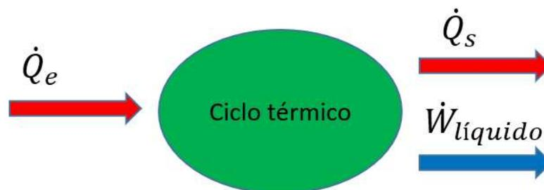
Figura 9 – Ilustração do volume de controle de um ciclo de Rankine ideal (elaborado pelo autor):
