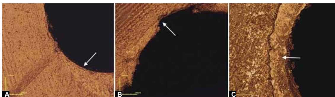
Figura 2. Imagens representativas do modo de falha obtidas por microscopia confocal de superfície.
