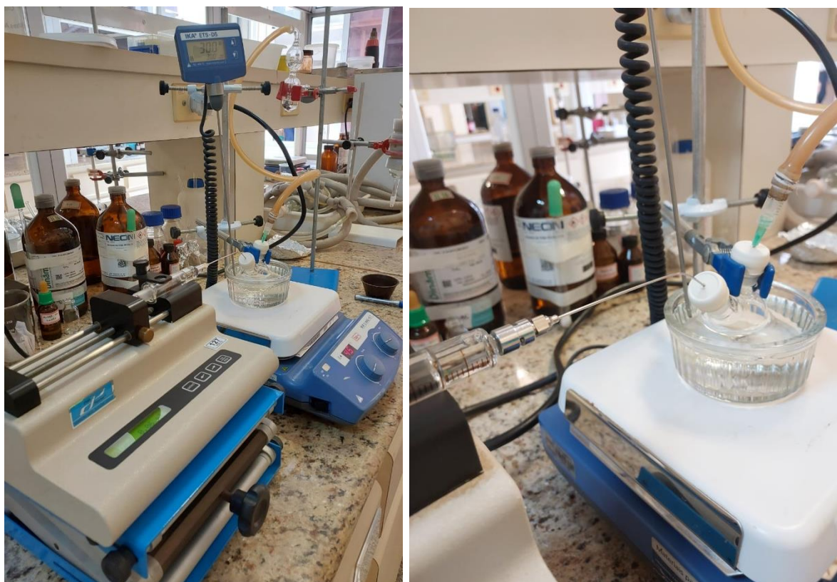
Figura 12. Sistema para adição do substrato em fluxo ao balão contendo CAL-A
