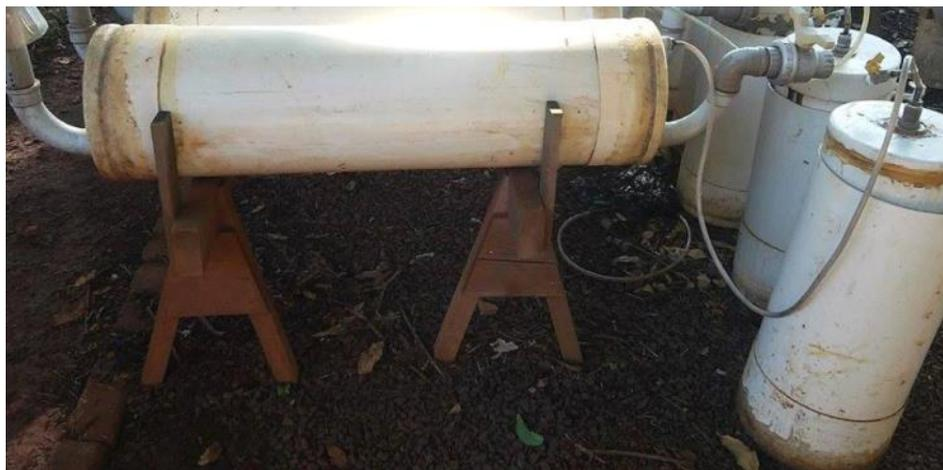
Figura 3: Visão geral do biodigestor contínuo e do gasômetro
