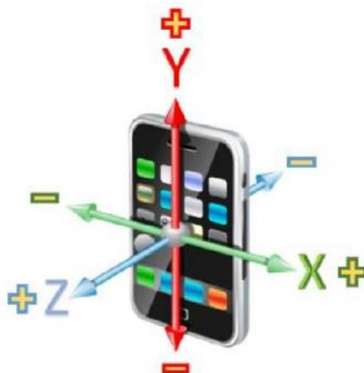
Figura 8 – Sistema de coordenadas de um smartphone
