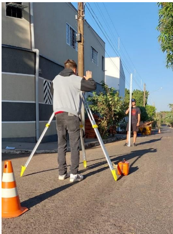
Figura 14 – Aplicação do método nível e mira no campo
