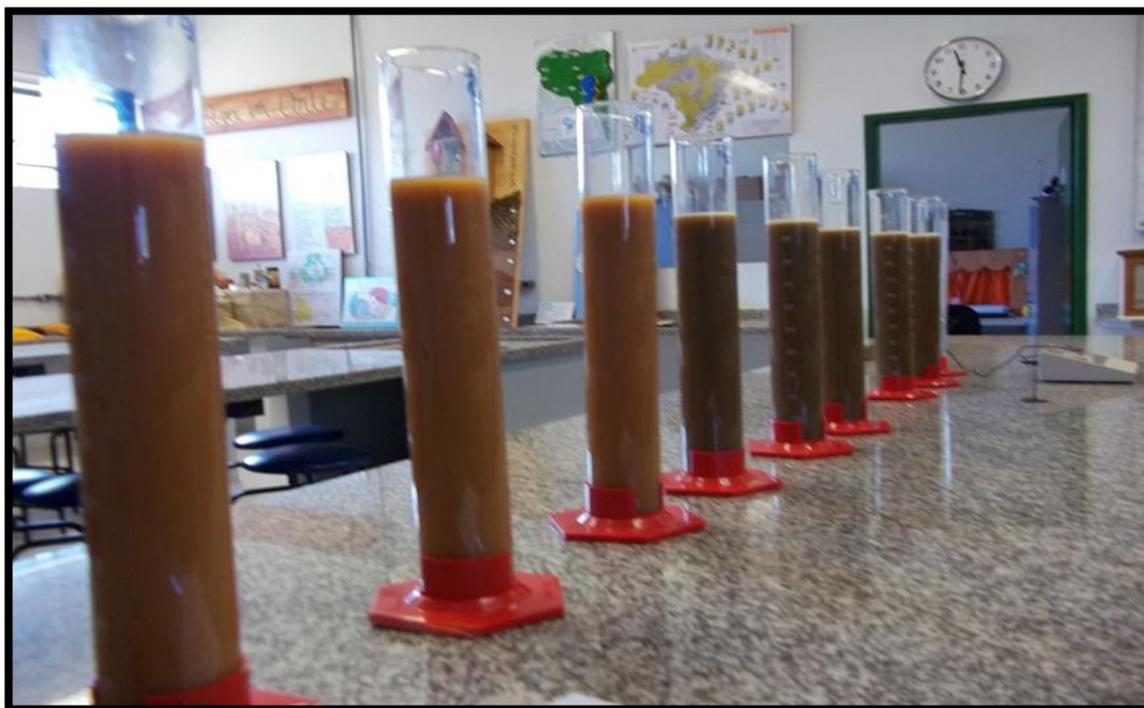
Figura 13: Uma das etapas da análise textural das amostras coletadas no aterro
