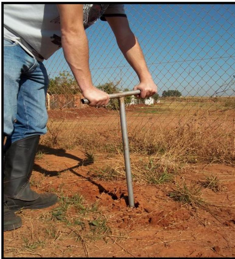
Figura 12: Coleta das amostras de solo próxima a cerca do aterro controlado.
