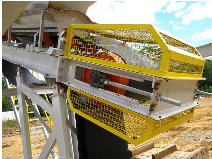
Figura 11 – Esticador de correia por parafuso.
