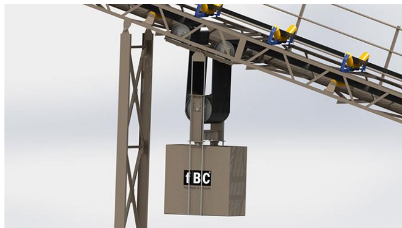
Figura 12 – Esticador por gravidade vertical.
