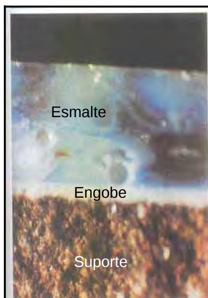
Figura 7: Esquema revestimento cerâmico-engobe-esmalte (BIFFI, 2002).
