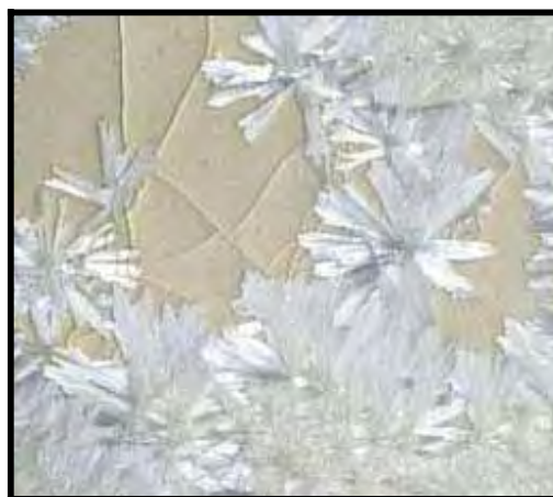
Figura 12: Aspecto de cristais em esmalte contendo zinco (PIMENTA, 2007)
