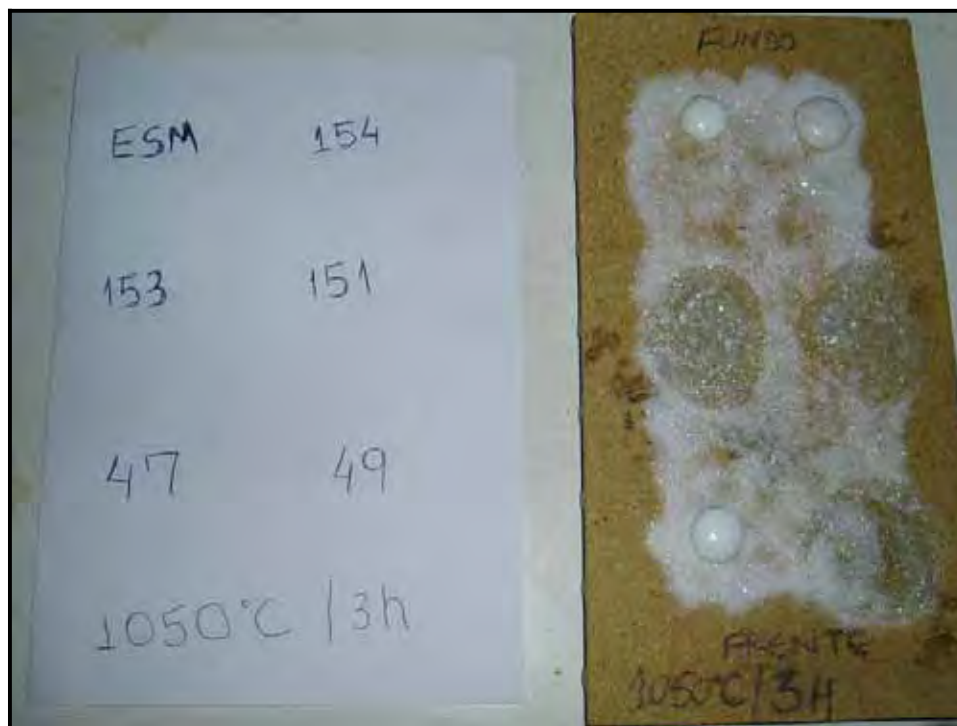
Figura 57: Pastilhas fundidas de esmaltes cerâmicas queimadas a 1050°C com 3 horas de patamar observam-se a diferença de fusibilidade das pastilhas de fritas.
