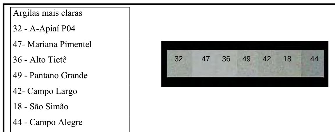
Figura 13: Quadro contendo argilas plásticas pré-selecionadas com as respectivas cores de queima.
