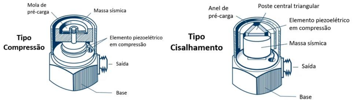
Figura 21 – Ilustração tipos de construção dos acelerômetros piezoelétricos
