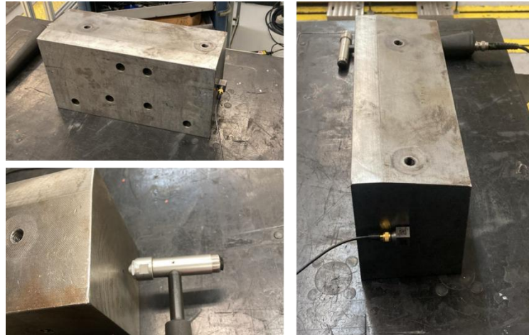
Figura 48 – Bloco de aço com acelerômetro
