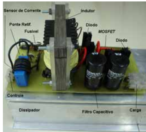
Figura 5.10 – Módulo elevador de tensão.
