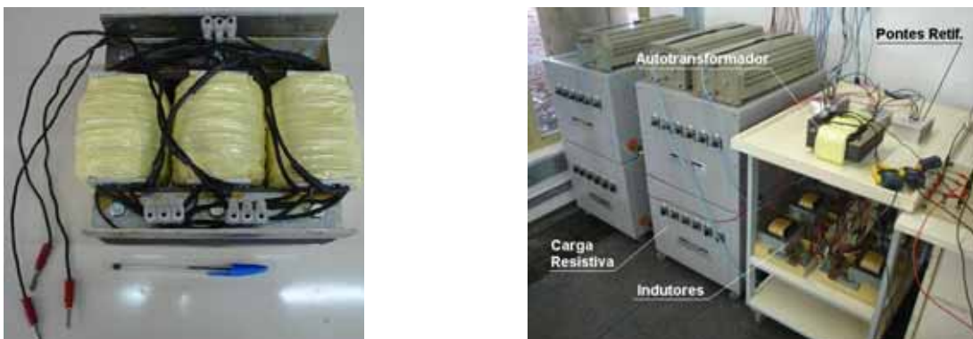
Figura 5.1 – Autotransformador \Delta -Diferencial e montagem experimental.
