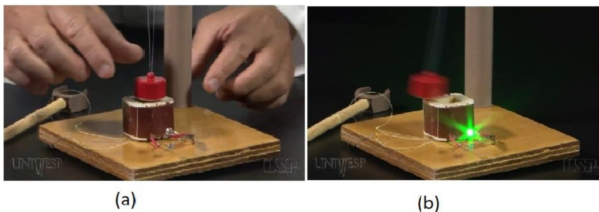
Figura 29 – Pêndulo formado com um ímã permanente. Na figura (a) o pêndulo está em posição de equilíbrio próximo a uma bobina conectada a dois LEDs. Na figura (b) o pêndulo oscila. Ao passar próximo da bobina, os LEDs emitem brilho.
