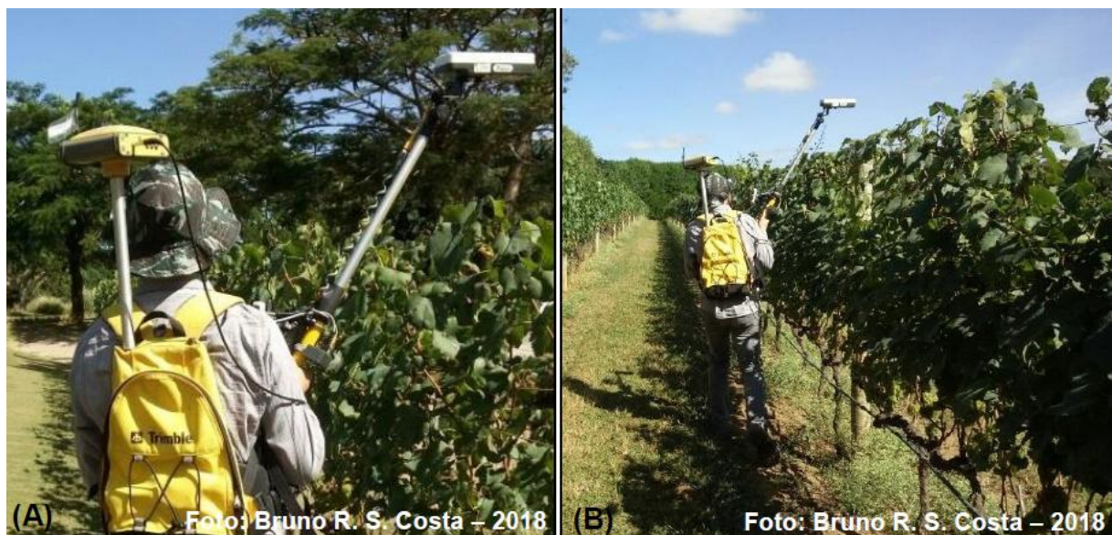
Figura 2 - Sensor Crop Circle ACS-430 (Holland Scientific Inc., Lincoln, NE, EUA) acoplado a um receptor GNSS HiPer® GGD (TOPCON, Pleasanton, CA, EUA) (A) e aquisição de dados de reflectância do dossel de videiras por caminhada (B)
