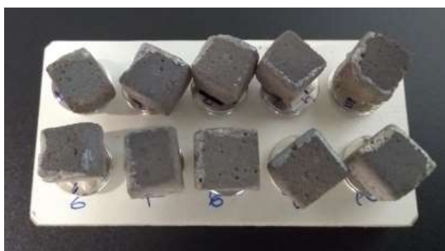
Figura 19 – Amostras preparadas para ensaio de microscopia, metalizadas em ouro e fixas com fita condutora de carbono dupla face em porta-amostra de alumínio.
