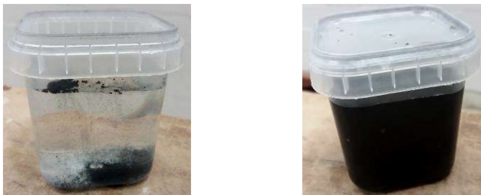
Figura 15 – Dispersão de OGR na água da mistura das argamassas.
