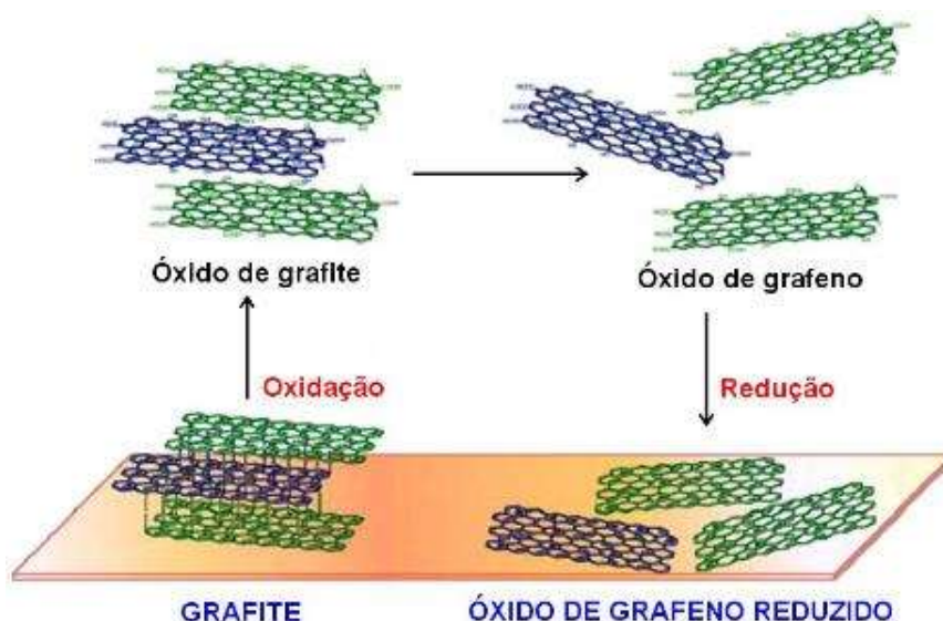
Figura 8 – Obtenção do OGR a partir do grafite (CHUA e PUMERA, 2014).
