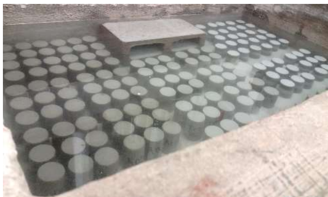
Figura 16 – Tanque com água não corrente saturada com cal, amostras em cura úmida.
