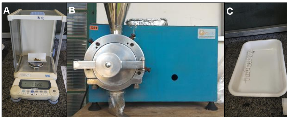
Figura 3 - A - Balança de alta precisão com pesa-filtro; B – Moinho; C - pesafiltro na forma de cartucho.
