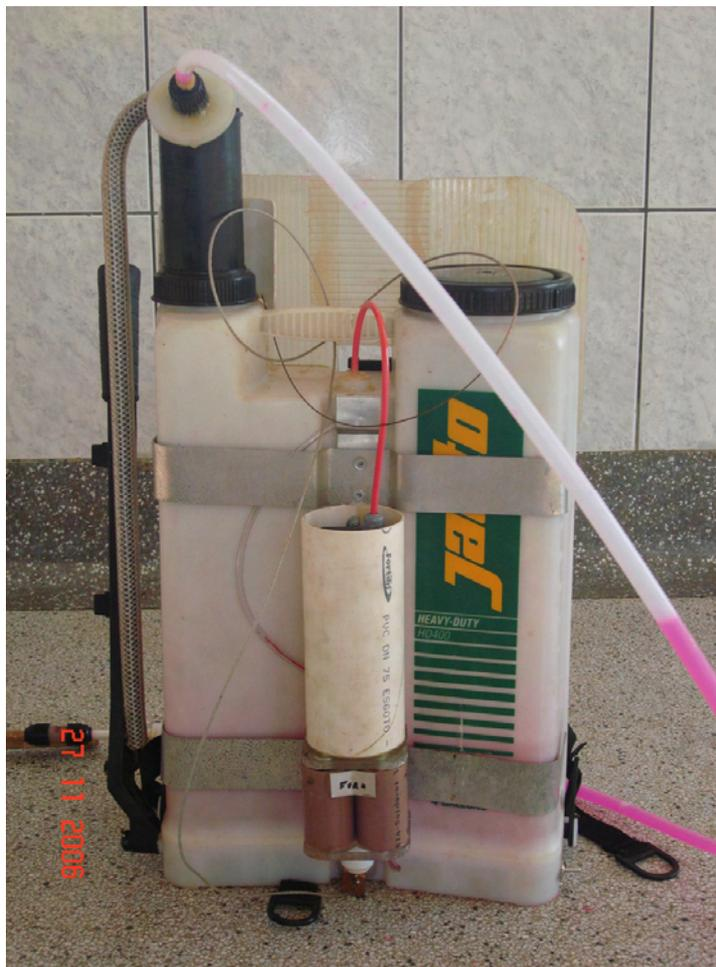
Figura 6. Protótipo de pulverizador costal eletrostático com acionamento manual desenvolvido pela Embrapa Meio Ambiente, em parceria com a empresa Máquinas Agrícolas Jacto S.A.
