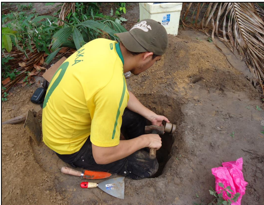
Figura 5: Retirada de amostra indeformada do solo com anel volumétrico.
