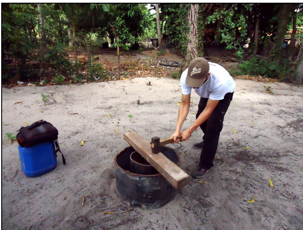
Figura 11: Cilindros sendo cravados no solo a 15 cm de profundidade com auxílio de marreta.
