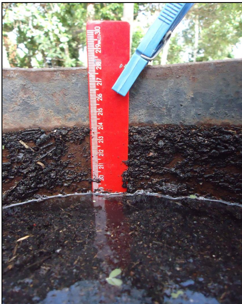
Figura 13: Leitura do volume d'água dentro do cilindro menor.
