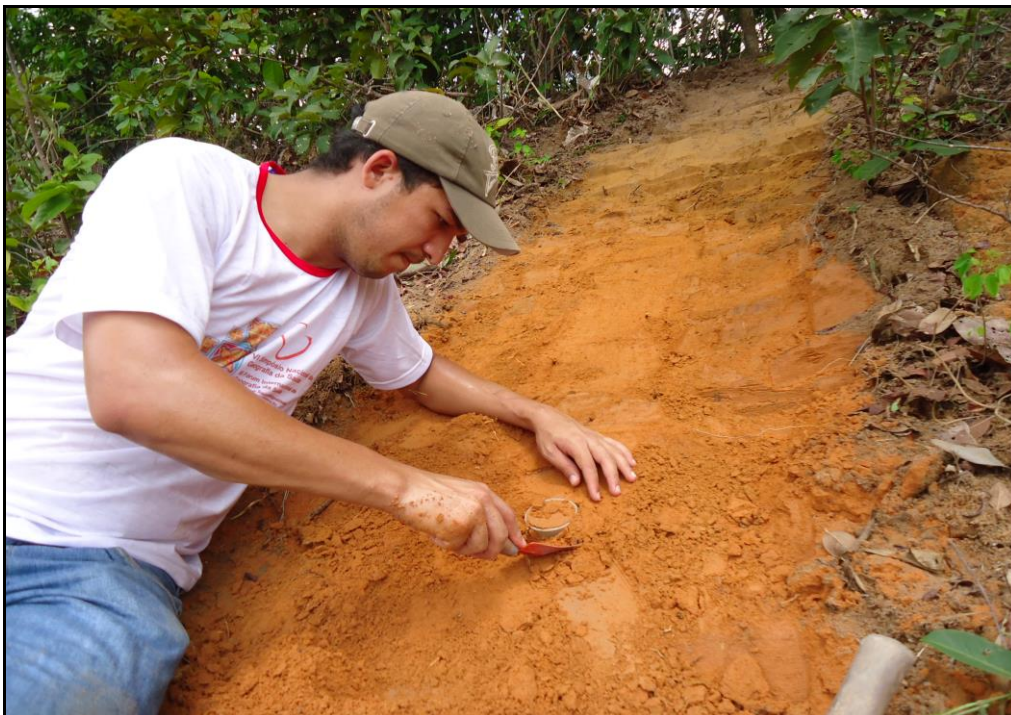
Figura 6: Retirada do anel volumétrico com amostra indeformada.
