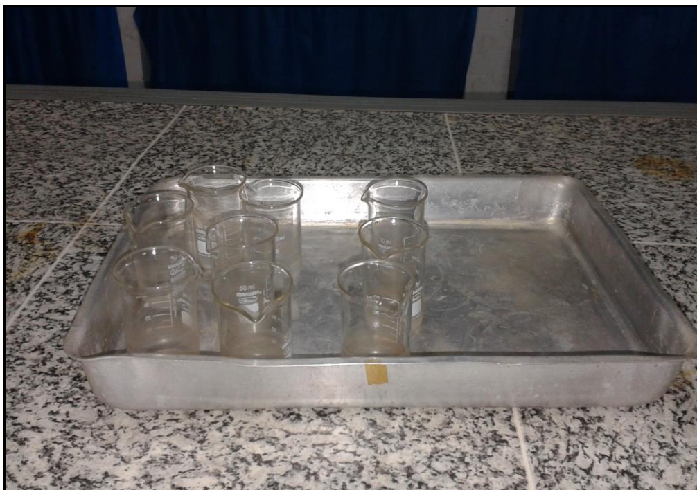
Figura 21: Béqueres com pesos iniciais registrados e prontos para serem levados à estufa.
