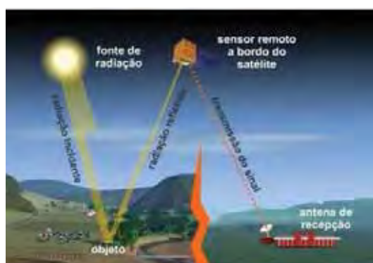
Figura 17 - Exemplo de coleta de informação da superfície da terra por meio de sensoriamento remoto orbital e o papel da radiação eletromagnética neste processo.
