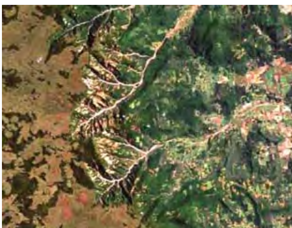
Figura 16 - Imagens do sensor TM LANDSAT-5 dos escorregamentos ocorridos em dezembro de 1995 na Serra Geral (SC)
