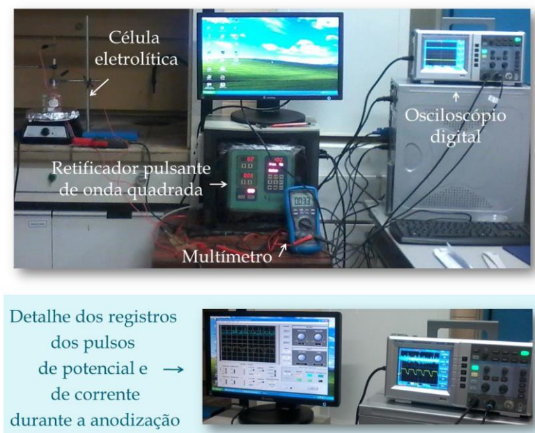
Figura 2 – Arranjo experimental utilizado nos ensaios de anodização
