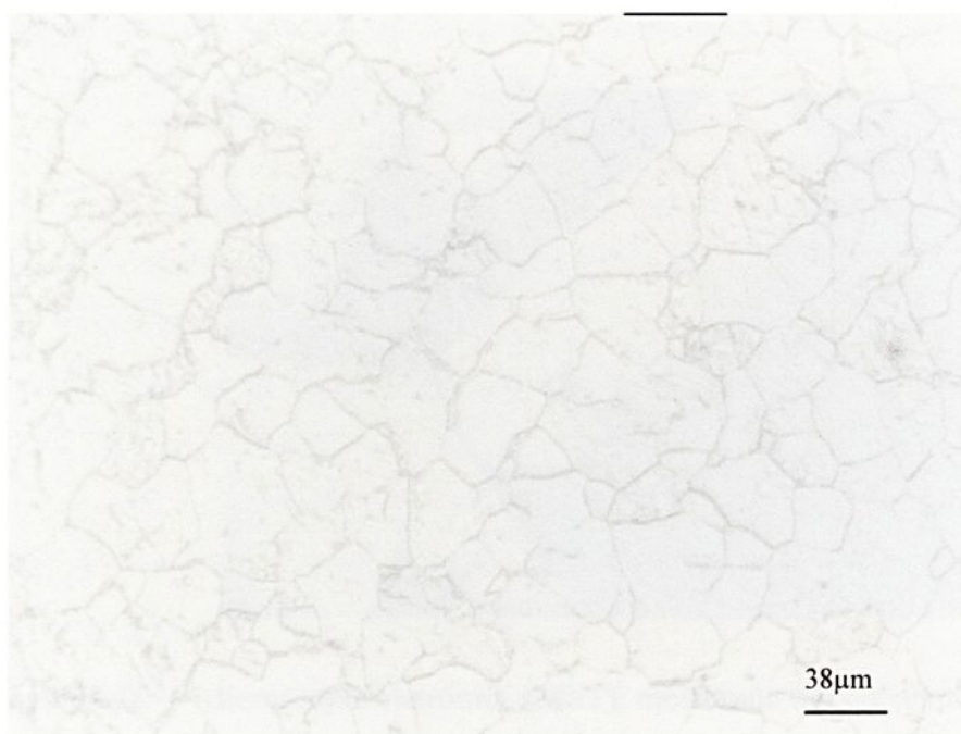
Figura 4.17 - Microscopia óptica (MO), microestrutura do aço recozido.
