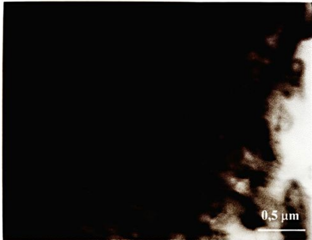
Figura 4.52 - Microscopia eletrônica (MET), mostrando discordâncias alinhadas na fase bainítica, localizada entre as fases martensita (escura) e ferrita (clara). Aço bifásico B1, ensaiado a 615 MPa, até 6% da vida estimada.
