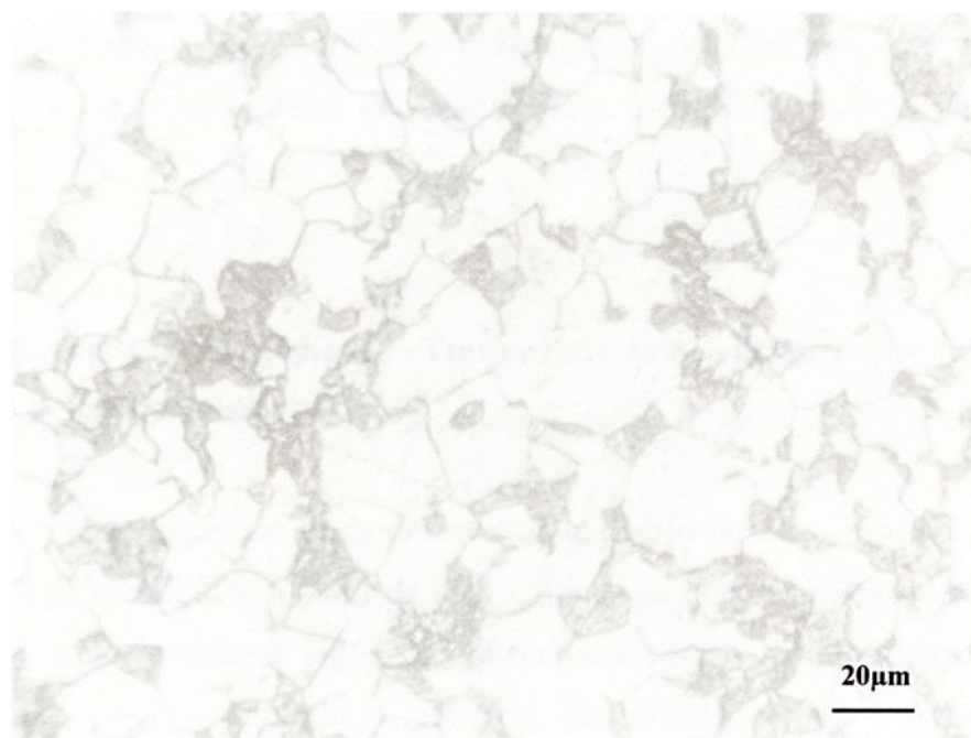
Figura 4. 38 - Microscopia Óptica (MO), mostrando a microestrutura do aço bifásico obtida na condição 1 (B1).
