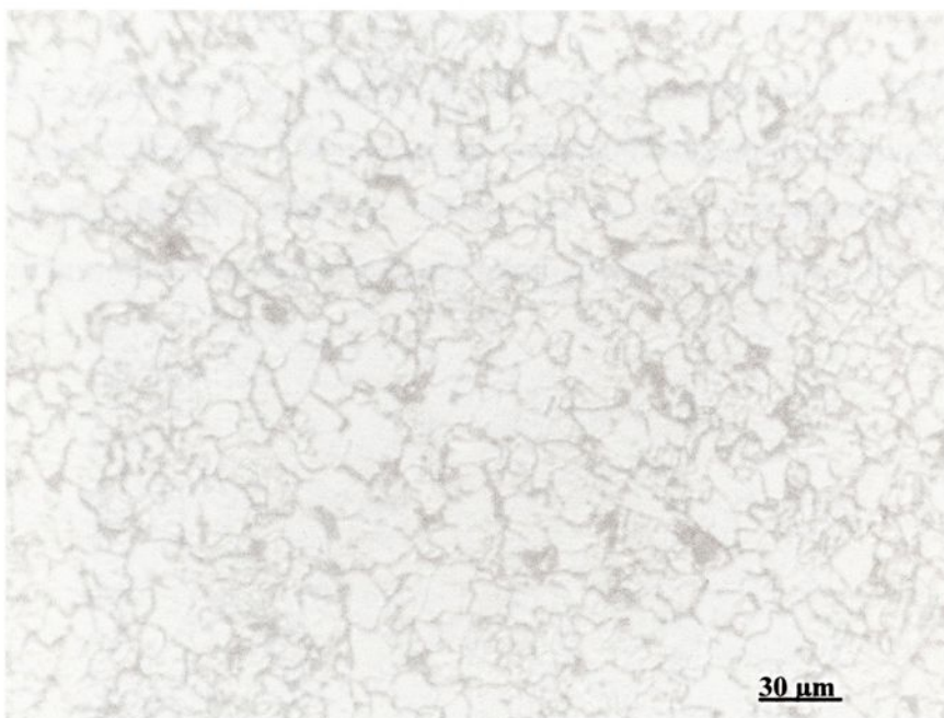
Figura 4.5 - Microscopia Óptica (MO), microestrutura do aço laminado.
