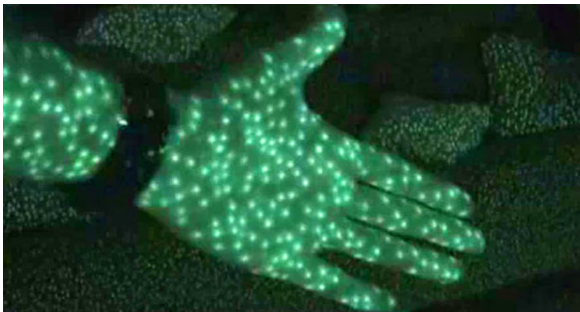
Figura 4 – Pontos infravermelhos projetados pelo Kinect.
