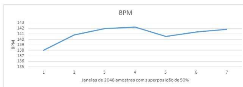
Figura 27 - Resultado da média dos períodos de cada janelamento de um sinal de 15 segundos
